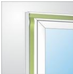
Rysunek 1: Sposób wyłożenia taśmą naroży okna.
